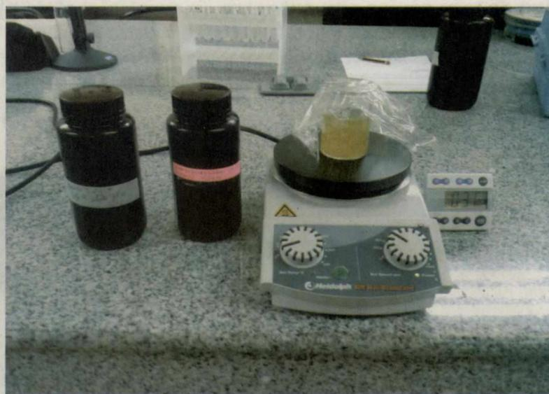
Figura 3. Experimento de hidrólisis de las proteínas presentes en la levadura utilizando la papaína como biocatalizador.
