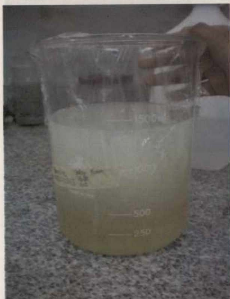
Precipitación alcohólica de la Bromelina
