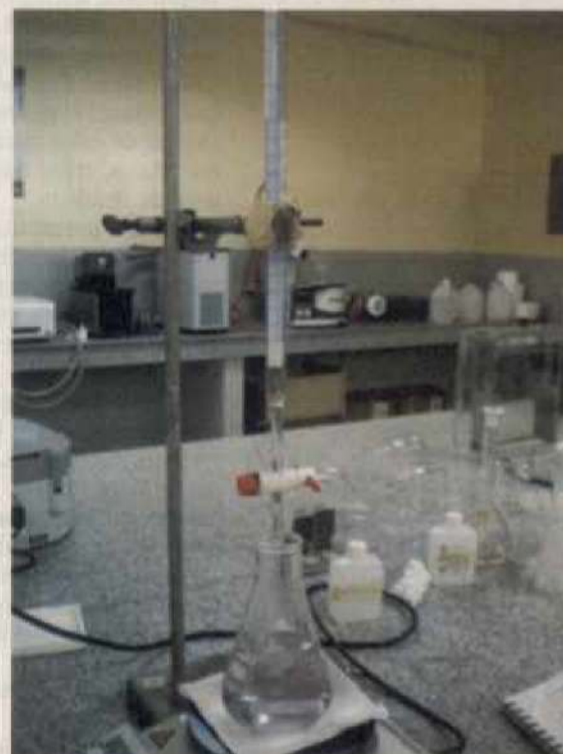
Titulación para cuantificar el contenido de proteínas
