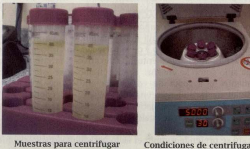
Figura 2. Proceso de centrifugación para la separación de la Bromelina
